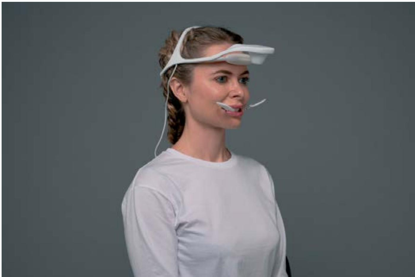
Рис. 1. Оптический аксиограф ProAxis
