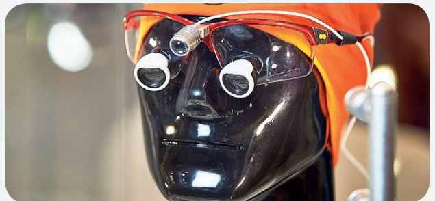
Рис. 8. Источник света на биноклярах
